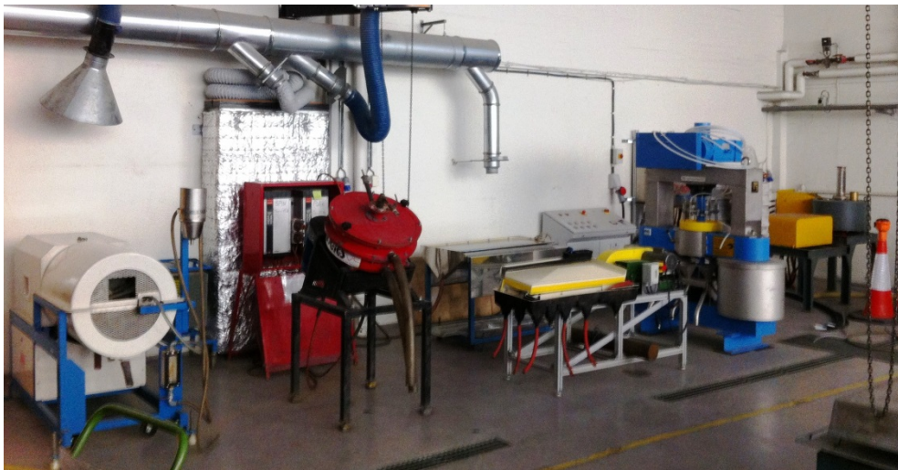
Figur 3. Oppredningshallen – utstyr for sterkfelt magnetseparasjon og gravitativ separasjon.
