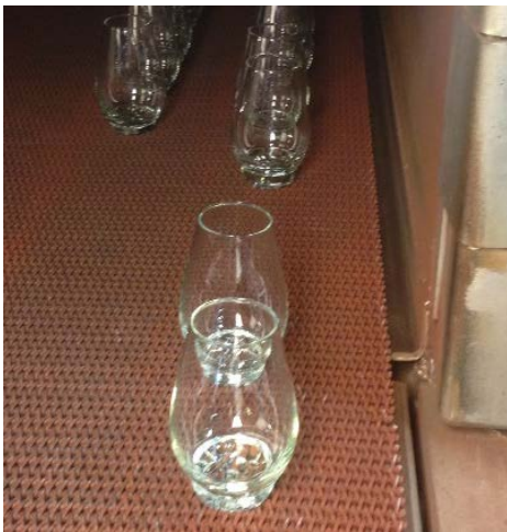
Figur 8. Etter produksjon kjøles glasset gradvis ned på et kjølerør fra 505°C til 0°C ila. 5 timer.
