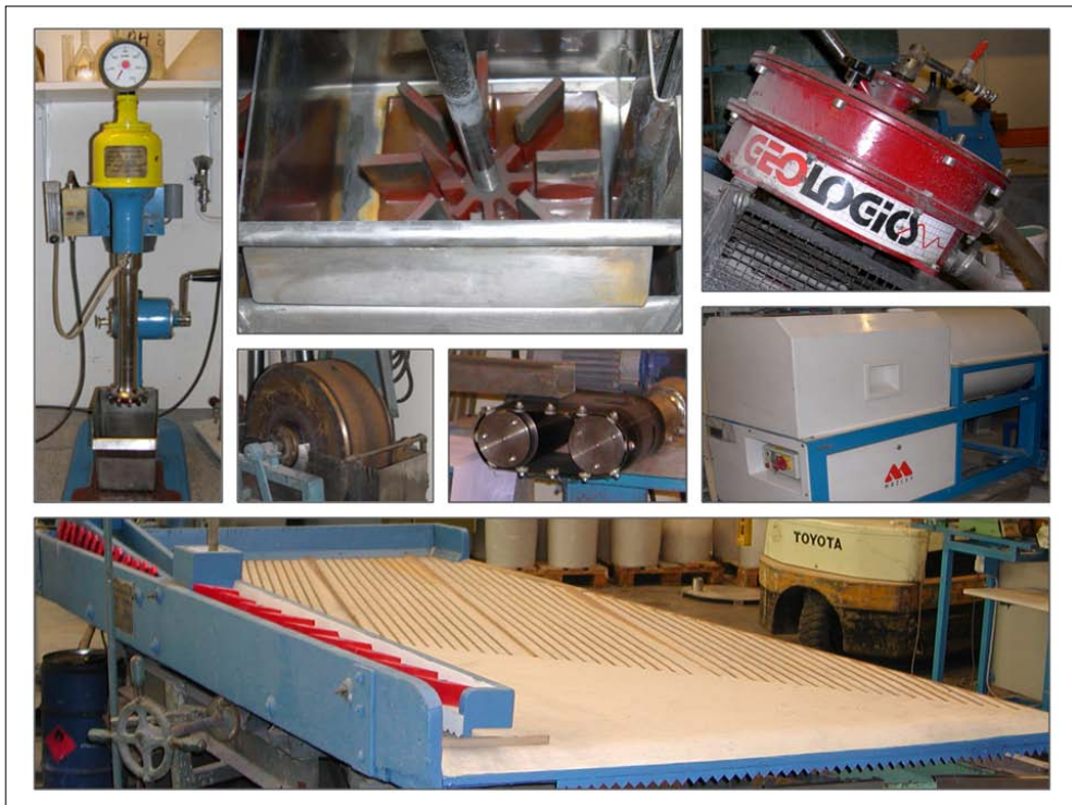
Figur 4. Benkeflotasjonscelle (øverst til venstre), impeller/stator i pilot flotasjonscelle (i midten øverst), Kelsey jig (øverst til høyre), svakfelt og sterkfelt magnetseparatorer (sentralt i bildet), Multi Gravity Separator (til høyre) og vaskebord (nederst).
